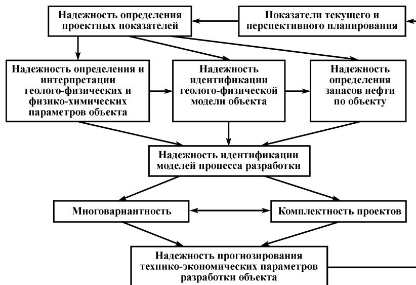
Рис. 1.6. Компоненты, определяющие надежность прогнозирования показателей разработки нефтегазовых месторождений
